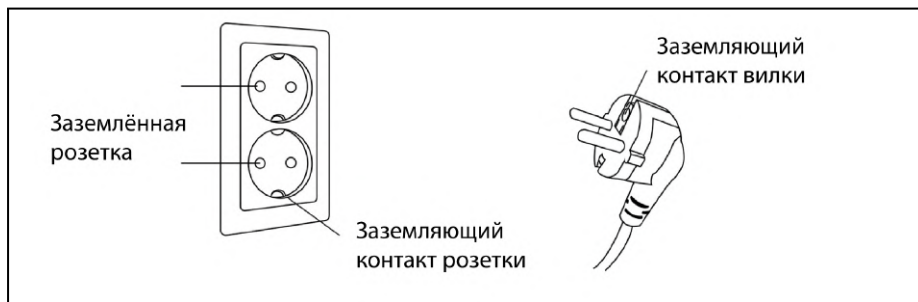
Рисунок 41 — Правильное заземление массажного кресла
