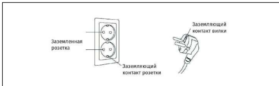
Рисунок 61 — Правильное заземление массажного кресла
